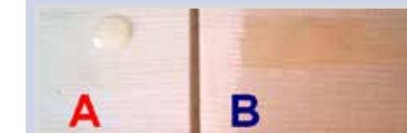
La stessa tavoletta dopo 18 minuti: nella parte A l'acqua è ancora ferma sulla superficie, mentre nella parte B è stata completamente assorbita dal legno
