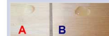
Tavoletta di Abete a cui sono state applicate alcune gocce d'acqua. La parte A è verniciata con Remmers GW311 mentre la parte B è naturale
